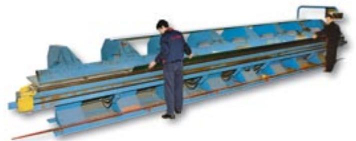
Hidraulična savijačica 10 metara
