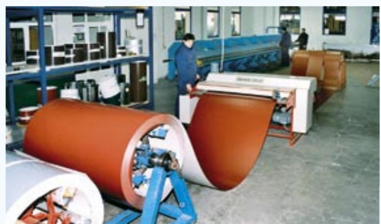
Limovi u proizvodni proces ulaze u rolama standardnih širina, obično 1250 ili 1000 mm. U prvoj fazi proizvodnje vrši se rezanje limova na potrebnu dimenziju. Ta operacija se odvija na automatskoj numerički upravljanoj mašini za uzdužno i poprečno rezanje limova. Opšavni limovi se profiliraju na hidrauličnim savijačicama do 6 ili 10 metara u jednom komadu, što omogućuje optimalizaciju procesa proizvodnje i smanjenja škarta.
