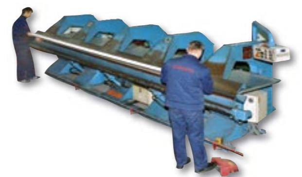
Hidraulična savijačica 6 metara
